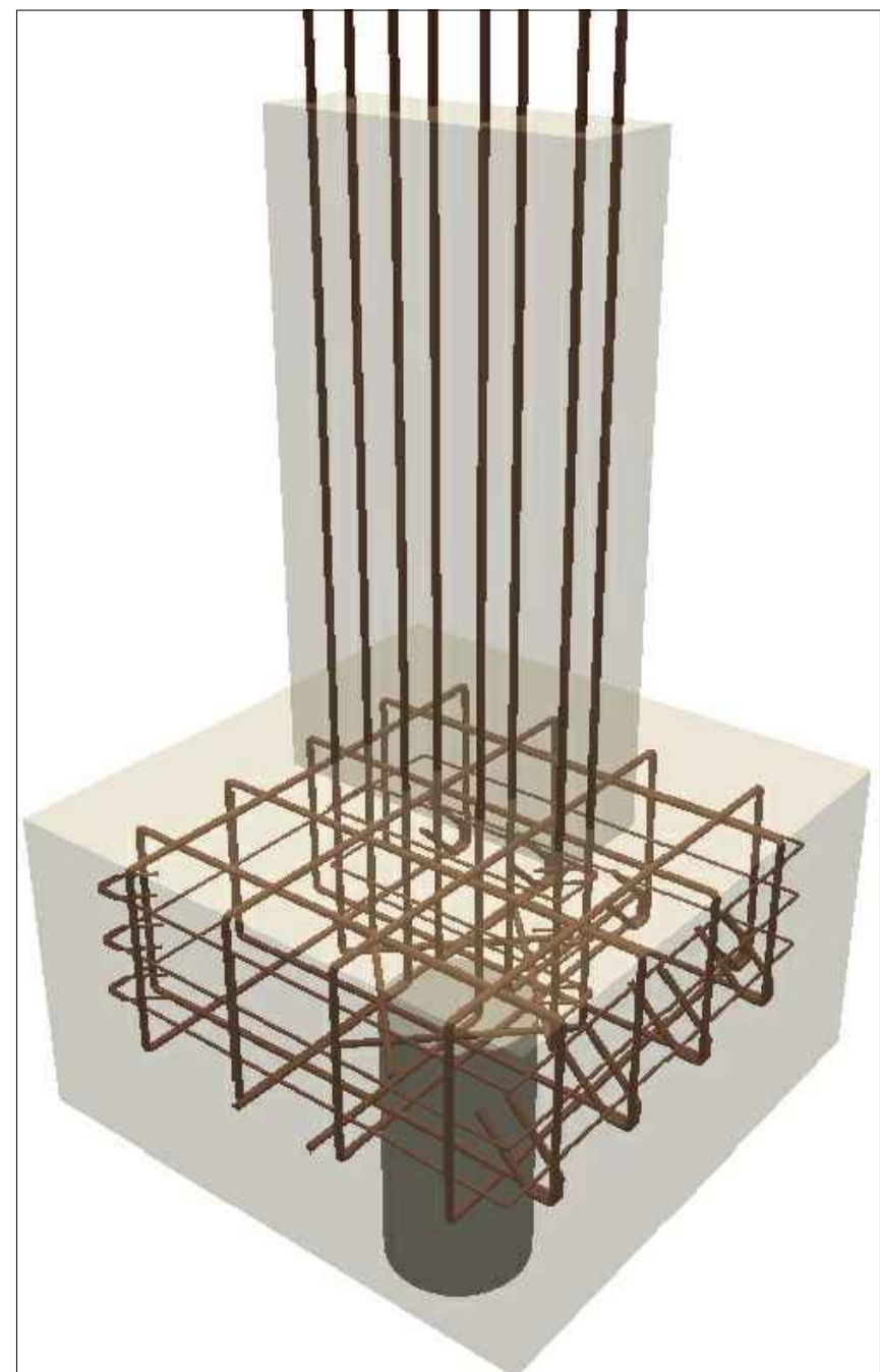
DETALHAMENTO DA FUNDAÇÃO EM 3D
